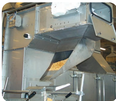
Część wysypowa z wbudowaną stacją napinającą
