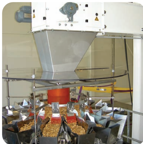
Napełnianie naważarki wielogłowicowej w przemyśle spożywczym
