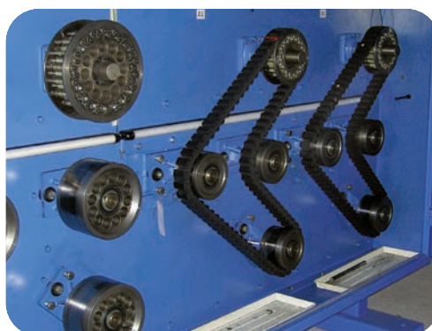
Urządzenie testujące jakość łańcuchów
